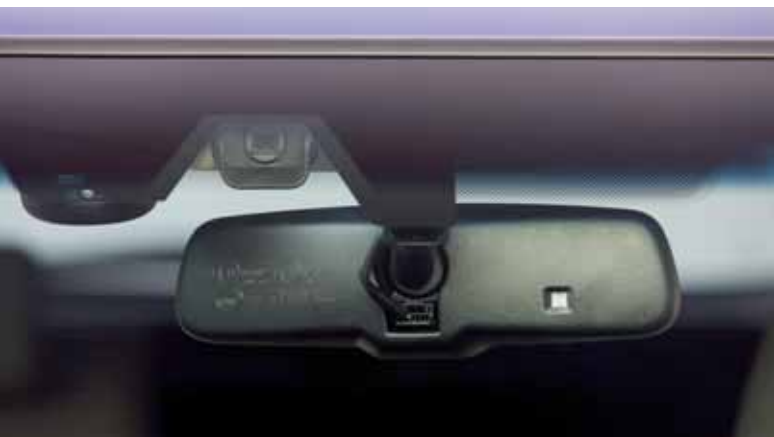
Kleiner Spion: die Kamera verbirgt sich geschickt hinter der Scheibe. Damit hat sie sogar noch einen besseren Blickwinkel als der Fahrer.
