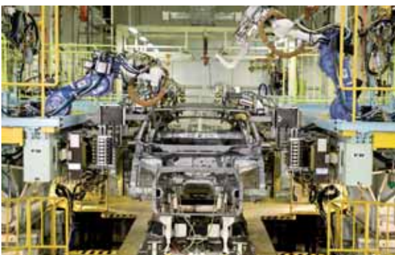
Moderne Schweißtechnik in der neuen Produktionsstraße im New Model Center in Tochigi.
