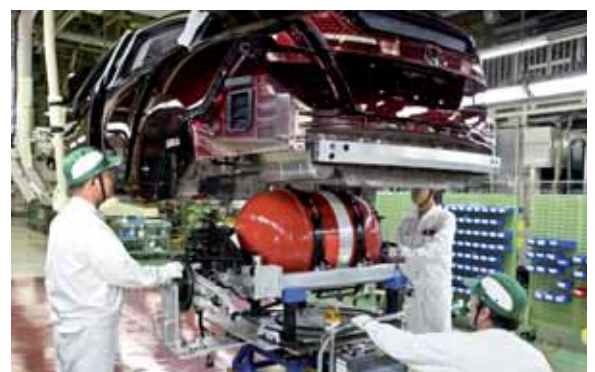
Höchste Präzision ist bei der Installation des stabilen Wasserstofftanks gefordert.
