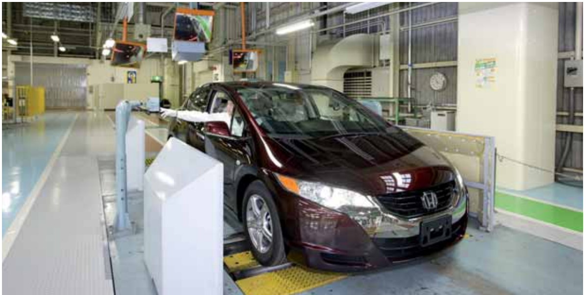
Im Honda Automobile New Model Center in Tochigi wurde die weltweit erste, speziell auf Brennstoffzellen ausgerichtete Fertigungsstraße erstellt. Bild oben zeigt den finalen Check des Brennstoffzellenfahrzeugs.
